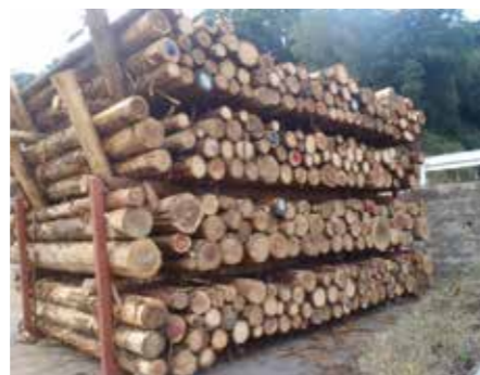
スギ、ヒノキ丸太約 300 本を写真のように井桁にはい積みして、そのうち無作為に選んだ 19 本について含水率を 1 か月ごとに 3 か月間測定した。
